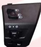
PANEL SWITCH LH NTRQ -DRUM BS4
